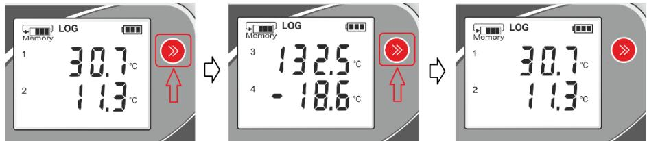
Dolní tlačítka slouží k přepínání mezi aktuálními hodnotami a Min/Max hodnotami:
