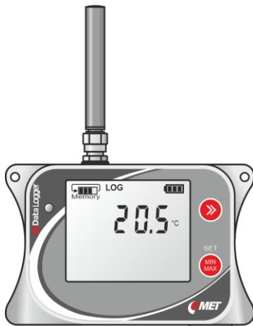
Tento model je vybaven pouze jedním interním čidlem pro měření teploty, není možné k němu připojit žádné další sondy a snímače. Vyznačuje se jednoduchým kompaktním provedením a relativně dlouhou odezvou na skokovou změnu teploty. Umístuje se přímo do měřeného prostoru. Vzhledem k tomu, že při nabíjení interní baterie vzniká parazitní teplo, může být přesnost měření po dobu nabíjení ovlivněna až o 1 °C.
