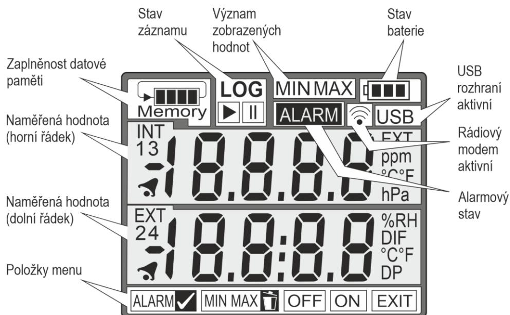
**Zaplněnost datové paměti** – poskytuje informaci o aktuálním stavu volného místa v datové paměti. Pokud nápis *Memory* bliká, znamená to, že byl překročen nastavený limit zaplněnosti paměti. Tento limit se nastavuje v konfiguraci přístroje a lze mu přiřadit různé akce (optická a akustická signifikace, odeslání SMS zpráv).
