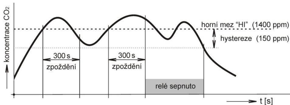
**Dolní mez „Lo“** - relé sepne, když měřená hodnota klesne pod nastavenou hodnotu dolní meze na dobu delší než je nastavená doba „zpoždění“. Relé rozepne, když měřená hodnota vzroste nad úroveň dolní meze zvětšené navíc o hodnotu „hystereze“. Viz příklad.
