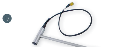
GSF 50TF (110 cm) obj. č. 601312 GSF 50TFK (43 cm) obj. č. 601313 zapichovací snímač s teplotním senzorem, pro měření do hloubky 40 cm popř. 107 cm, včetně 1 m připojovacího kabelu, určen pro štěpku, dřevitou vlnu, třísky, seno, slámu, obilí, piliny atd.
