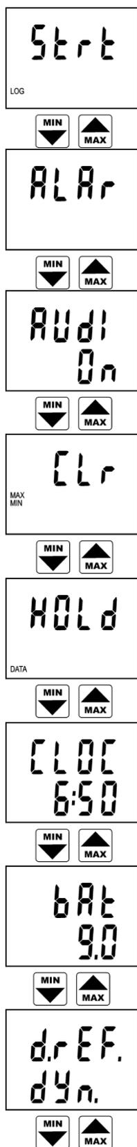
První nabídkou je START/STOP záznamu. Tato položka je ve dvou variantách: je-li záznam zastaven, nabízí se spuštění záznamu (symbol Strt = START), je-li naopak záznam už spuštěn, nabízí se zastavení záznamu (nápis STOP). Potvrzení (obou variant) této volby se provádí kl. ENTER. Upozornění: je-li indikována slabá baterie, nelze záznam spustit.
