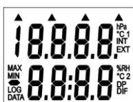
Přístroj se zapíná stiskem klávesy ON/OFF. Po zapnutí se na okamžik rozsvítí všechny znaky displeje pro jeho případnou kontrolu. Je-li klávesa ON/OFF při zapnutí přidržená stisknuta, svítí všechny znaky displeje až do uvolnění klávesy ON/OFF. Při běžném provozu se poté přístroj přepne do režimu měření a zobrazení hodnot měřených veličin.
