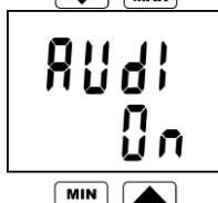
Indikuje zapnutí (On) nebo vypnutí (OFF) akustické signalizace překročení hranic alarmů. Stiskem klávesy ENTER lze aktuální stav změnit v opačný. Upozornění: je-li baterie už slabá, akustická signalizace z důvodu omezení odběru proudu nepracuje a to nezávisle na nastavení této volby.
