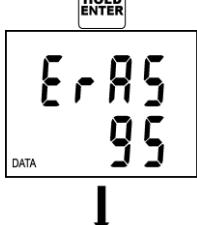
Tím je spuštěna procedura mazání, která trvá cca 16 s a její průběh je indikován na displeji průběžným zobrazením procentuální hodnoty velikosti už vymazané paměti (číslicemi 0 až 100).
