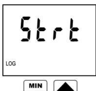
První nabídkou je START/STOP záznamu. Tato položka je ve dvou variantách: je-li záznam zastaven, nabízí se spuštění záznamu (symbol Strt = START), je-li naopak záznam už spuštěn, nabízí se zastavení záznamu (nápis STOP). Potvrzení (obou variant) této volby se provádí kl. ENTER. Upozornění: je-li indikována slabá baterie, nelze záznam spustit.
