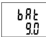
Zobrazuje se orientační hodnota napětí částečně zatížené baterie. Z této hodnoty lze posoudit stav baterie.
