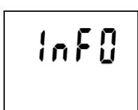
Po každém stisku klávesy ENTER se zobrazí postupně informace o nastaveném intervalu ukládání, aktuálním typu záznamu (MODE), stupni zaplnění paměti (MEMO - v automatickém záznamovém režimu se zobrazí zaplnění paměti v procentech, v manuálním režimu se zobrazí počet uložených záznamů) a servisní informace o verzi vnitřního ovládacího programu (horní řádek displeje) spolu s konfigurací přístroje vzhledem k měřeným veličinám (dolní řádek).
