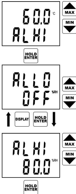
Nápis ALHI indikuje nastavovanou horní mez téhož alarmu. Postup nastavení hodnoty na požadovanou velikost je totožný s nastavením dolní meze alarmu. V případě potřeby je možno se vrátit zpět na nastavení dolní meze téhož alarmu klávesou DISPLAY. Stiskem klávesy ENTER je nastavená hodnota horní meze potvrzena.
