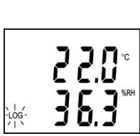
Nyní přístroj zobrazuje nastavený interval ukládání naměřených hodnot do paměti. Je-li třeba jej změnit, provede se nové nastavení klávesami se šípkami. Interval 10 sec je zobrazen jako **MIN 0:10**, minutové intervaly jsou zobrazeny **MIN x:00** a intervaly hodinové **x:Ho**. Nastavený interval se potvrdí kl. ENTER. Upozornění: je-li nastaven manuální typ záznamu, je tato položka přeskočena (interval se nenastavuje).
