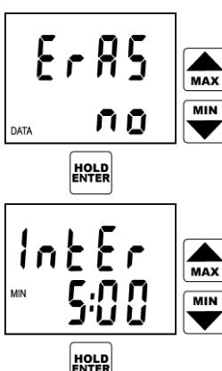
Přístroj dále nabízí možnost vymazání záznamové paměti (ERAS). Nemá-li být paměť před spuštěním záznamu vymazána, stačí potvrdit klávesou ENTER nabízenou volbu ERAS NO (nemazat).
