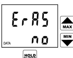
Přístroj dále nabízí možnost vymazání záznamové paměti (ERAS). Nemá-li být paměť před spuštěním záznamu vymazána, stačí potvrdit klávesou ENTER nabízenou volbu ERAS NO (nemazat).
