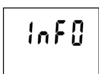
Po každém stisku klávesy ENTER se zobrazí postupně informace o nastaveném intervalu ukládání, aktuálním typu záznamu (MODE), stupni zaplnění paměti (MEMO - v automatickém záznamovém režimu se zobrazí zaplnění paměti v procentech, v manuálním režimu se zobrazí počet uložených záznamů) a servisní informace o verzi vnitřního ovládacího programu (horní řádek displeje) spolu s konfigurací přístroje vzhledem k měřeným veličinám (dolní řádek).
