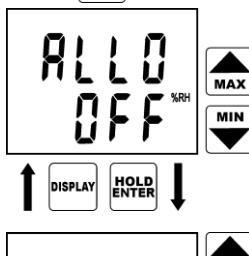
Přístroj dále nabízí nastavení alarmu další veličiny (relativní vlhkost). Postup nastavení alarmů všech veličin je zcela totožný s výše uvedeným nastavením alarmu teploty. Nebude-li alarm pro danou veličinu využíván, je možno jej vypnout nastavením dolní meze alarmu na její maximální nastaviteľnou hodnotu, jak je tomu v tomto případě. Číselná hodnota dolní meze alarmu se pak změní na nápis OFF.
