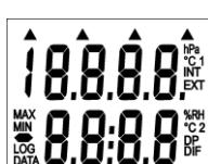
Přístroj se zapíná stiskem klávesy ON/OFF. Po zapnutí se na okamžik rozsvítí všechny znaky displeje pro jeho případnou kontrolu. Je-li klávesa ON/OFF při zapnutí přidržena stisknuta, svítí všechny znaky displeje až do uvolnění klávesy ON/OFF. Při běžném provozu se poté přístroj přepne do režimu měření a zobrazení hodnot měřených veličin.
