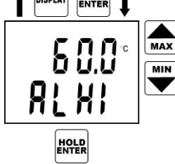
Nápis ALHI indikuje nastavovanou horní mez téhož alarmu. Postup nastavení hodnoty na požadovanou velikost je totožný s nastavením dolní meze alarmu. V případě potřeby je možno se vrátit zpět na nastavení dolní meze téhož alarmu klávesou DISPLAY. Stiskem klávesy ENTER je nastavená hodnota horní meze potvrzena.
