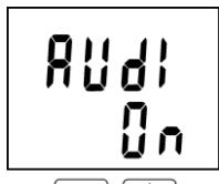
Indikuje zapnutí (On) nebo vypnutí (OFF) akustické signalizace překročení hranic alarmů. Stiskem klávesy ENTER lze aktuální stav změnit v opačný. Upozornění: je-li baterie už slabá, akustická signalizace z důvodu omezení odběru proudu nepracuje a to nezávisle na nastavení této volby.
