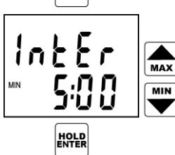
Nyní přístroj zobrazuje nastavený interval ukládání naměřených hodnot do paměti. Je-li třeba jej změnit, provede se nové nastavení klávesami se šipkami. Interval 10 sec je zobrazen jako MIN 0:10, minutové intervaly jsou zobrazeny MIN x:00 a intervaly hodinové x:Ho. Nastavený interval se potvrdí kl. ENTER. Upozornění: je-li nastaven manuální typ záznamu, je tato položka přeskočena (interval se nenastavuje).
