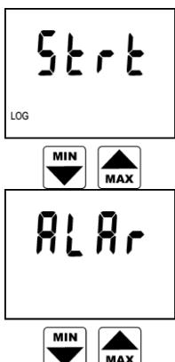
První nabídkou je START/STOP záznamu. Tato položka je ve dvou variantách: je-li záznam zastaven, nabízí se spuštění záznamu (symbol Strt = START), je-li naopak záznam už spuštěn, nabízí se zastavení záznamu (nápis STOP). Potvrzení (obou variant) této volby se provádí kl. ENTER. Upozornění: je-li indikována slabá baterie, nelze záznam spustit.
