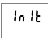
Došlo-li od posledního nastavení času ve vnitřních hodinách přístroje k poklesu napětí baterie pod kritickou mez nebo k jejímu odpojení na dobu delší než cca 1 min, proběhne po zapnutí nová inicializace přístroje (nápis INIT může svítit až 12 s!).
