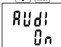
Indikuje zapnutí (On) nebo vypnutí (OFF) akustické signalizace překročení hranic alarmů. Stiskem klávesy ENTER lze aktuální stav změnit v opačný. Upozornění: je-li baterie už slabá, akustická signalizace z důvodu omezení odběru proudu nepracuje a to nezávisle na nastavení této volby.
