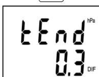
Jako poslední se zobrazuje hodnota tlakové tendence (hPa), která představuje rozdíl tlaku aktuálního a tlaku před 3 hodinami. Jestliže není přístroj zapnutý alespoň 3 h, není hodnota tlakové tendence ještě dostupná a na displeji jsou zobrazeny pomlčky (--).
