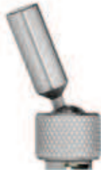
2.4816 Ø 8 mm h6, schwenkbar ± 40°
