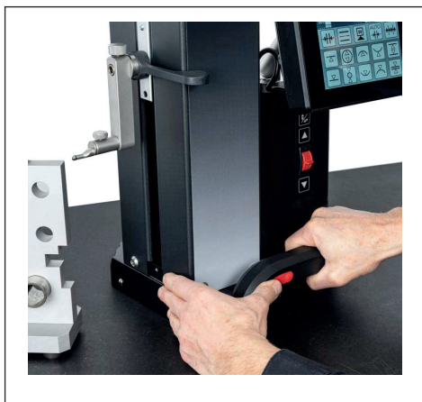
Obr. 8 Pohyb výškoměru pomocí aktivovaného vzduchového ložiska
