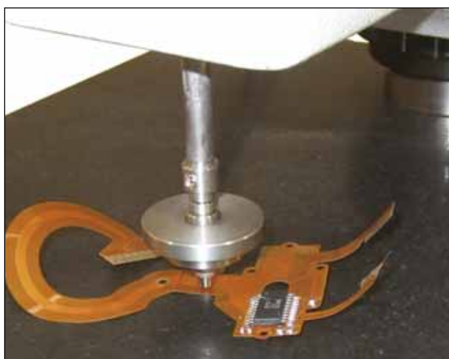
Vřeteno s nainstalovaným volitelným závažím
